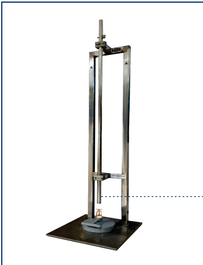
آزمون ضربه اسپرینکلر Sprinkler impact test
